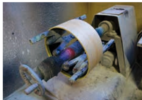
平らな木材を円柱の胴に加工する機械。胴の塗装も行う。
