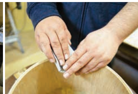
スネアドラムの胴にやすりをかける。見えない部分だが重要な作業。
