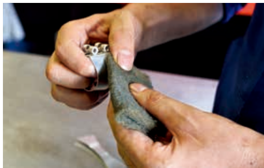
製造工程のひとつを終えると、必ず富永さんによる調整をして次の工程へ。アルマイト処理は金属の凹凸や傷が塗装に影響してしまうため、丁寧にやすりをかける。
